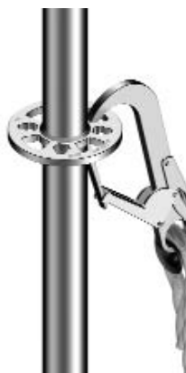
Fig. 4: Anslutning i kransens samtliga hål är möjligt. (OBS! EJ tillåtet på Alu-Allround).
