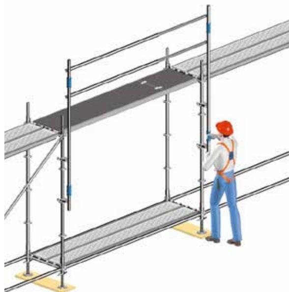
Fig. 4: Detaljförstoring: Montering av Layhers Montageräcke.
