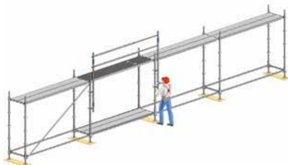
Fig. 2: Montering av Layhers Montageräcke.
